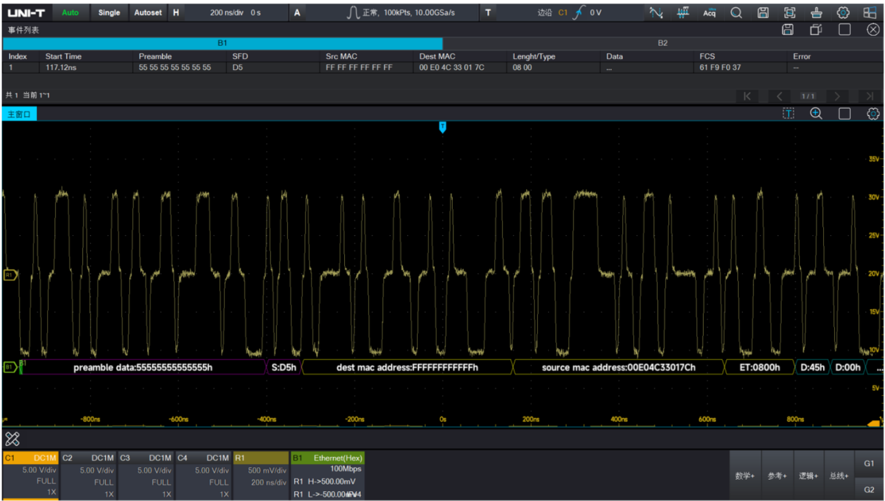
分析 100M 以太网总线。总线波形提供时间相关的解码后的包内容，包括前导数据、起始帧界定符、目的媒体控制访问地址、源地址等，事件列表展示采集的所有包内容
