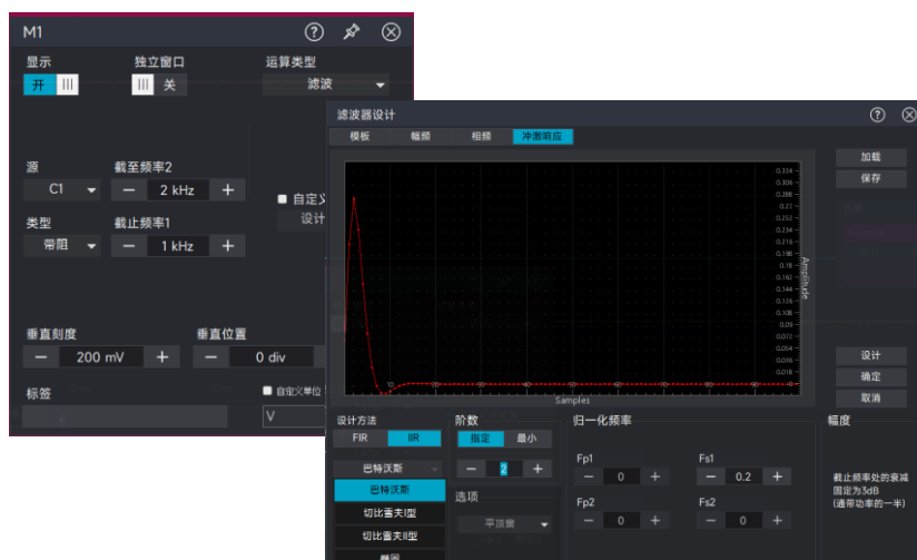
使用自定义滤波器创建对话框，图形化显示滤波器类型，响应，阶数等，可保存调用滤波器设计
