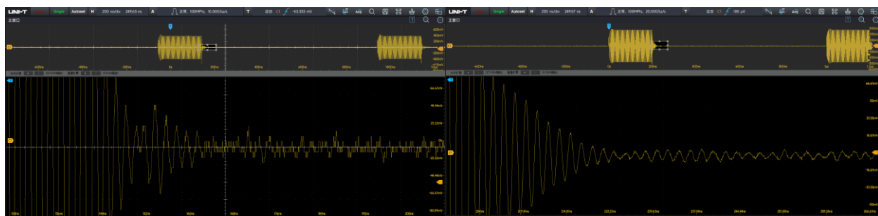
8bit (左) 在 1V 的动态范围下垂直放大 25 倍已经失真，12bit (右) 在高动态范围测试时对小信号的细节仍能清晰分辨
