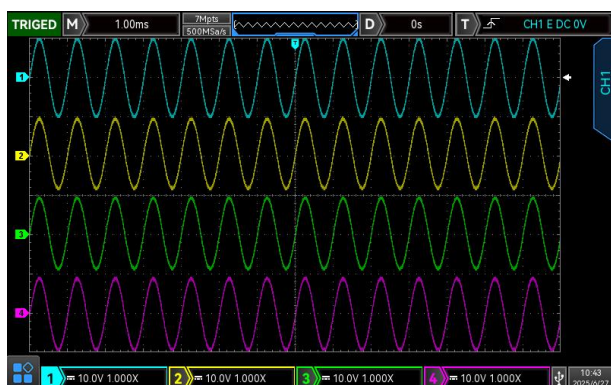
等性能 4 通道同时输出 20Vpp 信号
