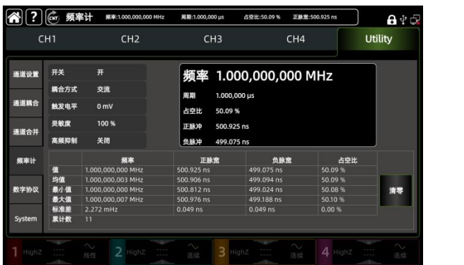
高精度硬件频率计，可测 100mHz ~ 800MHz 的频率范围。
